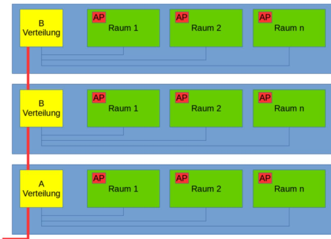
In Gebäudeteilen sind zentrale Verkabelungspunkte sinnvoll, die in brandhemmenden Netzwerkschränken nach dem gängigen Stand der Technik einzurichten sind.
