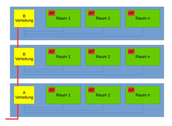
In Gebäudeteilen sind zentrale Verkabelungspunkte sinnvoll, die in brandhemmenden Netzwerkschränken nach dem gängigen Stand der Technik einzurichten sind.
